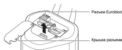
3 Отверткой с плоским жалом ослабьте винты клемм разъема Euroblock. Вставьте кабели в клеммы и затяните винты. Убедитесь, что кабели нельзя извлечь из клемм.
