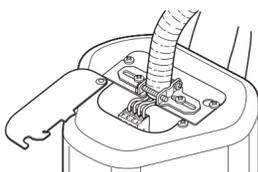
8 Закройте крышку разъема и затяните винт крышки.
