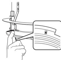
3 Отверткой поверните закрепляющий винт на пол-оборота против часовой стрелки. Это упростит установку зажима в канале.
