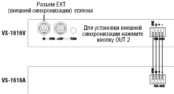
Рис. 20. Настройка синхронизации MTX (синхронизация от матрицы)
