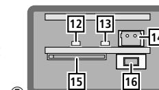
Die LED (12) signalisiert eine eingesetzte Karte.
