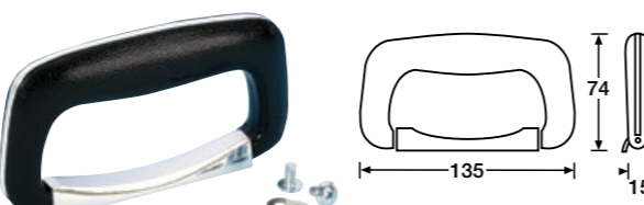
3438 BRIEFCASE DROP HANDLE Quality Briefcase drop handle. Solid black plastic grip with chrome decorative insert. Fixing plate chrome plated diecast. Fixings M5 x 10 mm (supplied), weight 100 g. KOFFERGRIFF Hochwertiger Koffergriff, schwarz mit Chromeinsatz. Abdeckkappe Druckguß verchromt. inkl. Schrauben M5 x 10 mm, Gewicht 100 g.
