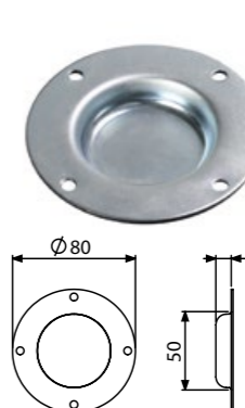
4905 SMALL STACKING DISH For all feet with \varnothing 38 mm. Can also be used as a small (unpunched) connector dish. Material steel, zinc plated, \rightarrow | \leftarrow 1.2 mm, Fixing Holes \varnothing 5.1 mm, weight 102 g. EINBAUSTAPELSCHALE Für alle Füße mit \varnothing 38 mm. Kann alternativ auch als (ungestanzte) Einbauschale für einzelne Buchsen genutzt werden. Material Stahl, verzinkt, \rightarrow | \leftarrow 1,2 mm Befestigungslöcher \varnothing 5,1 mm, Gewicht 102 g.
