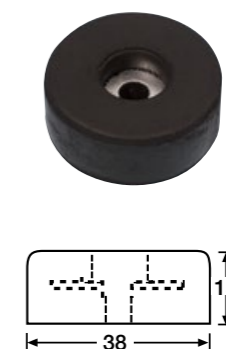
4907 15 mm RUBBER FOOT * Black, with steel insert. Fixing hole \varnothing 6.5 mm, weight 20 g. 15 mm GUMMIFUSS * Schwarz, mit eingelassener Stahlscheibe, Befestigungsloch \varnothing 6,5 mm, Gewicht 20 g.
