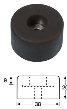
4909 20 mm RUBBER FOOT * Black, with steel insert. Fixing hole \varnothing 6.5 mm, weight 30 g. 20 mm GUMMIFUSS * Schwarz, mit eingelassener Stahlscheibe, Befestigungsloch \varnothing 6,5 mm, Gewicht 30 g.
