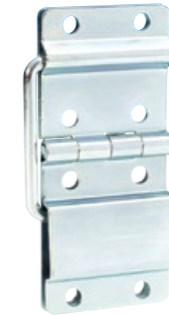
2524 / 2524CHR STRUT HINGE Extra heavy duty strut hinge with backplate. Steel, zinc or chrome plated Strut \varnothing 4.0 mm Fixing holes \varnothing 5.1 mm Weight 80 g FESTSTELLSCHARNIER Besonders schwere Ausführung mit Rückenplatte Stahl, verzinkt oder verchromt Feststeller \varnothing 4,0 mm Befestigungslöcher \varnothing 5,1 mm Gewicht 80 g
